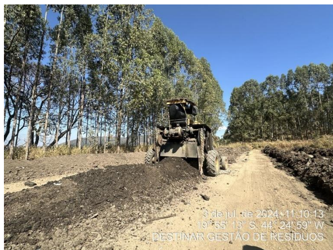
Foto 7: Trator realizando o revolvimento das leiras
