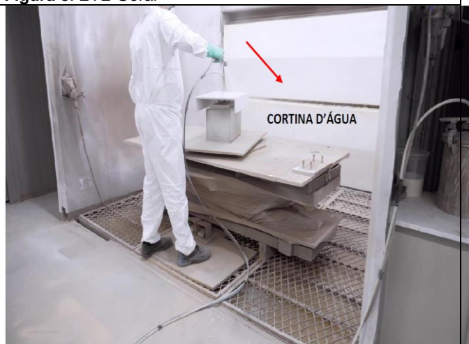
Figura 10. Cortina d'água (cabine de pintura)
