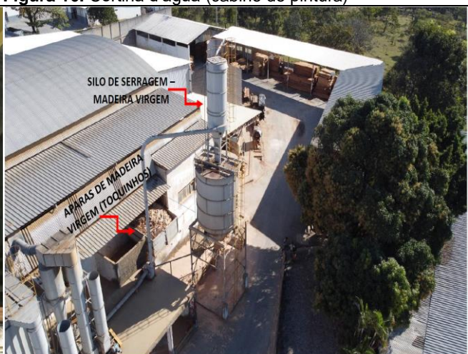
Figura 18. Armazenamento de serragem (silo) e caixotes de armazenamento de aparas de madeira
