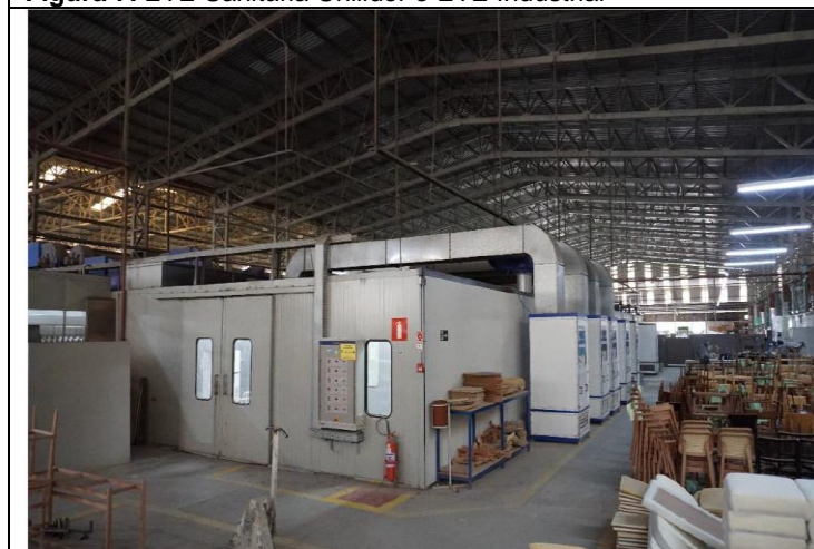
Figura 9. Cabines de pintura com pressurizadores
