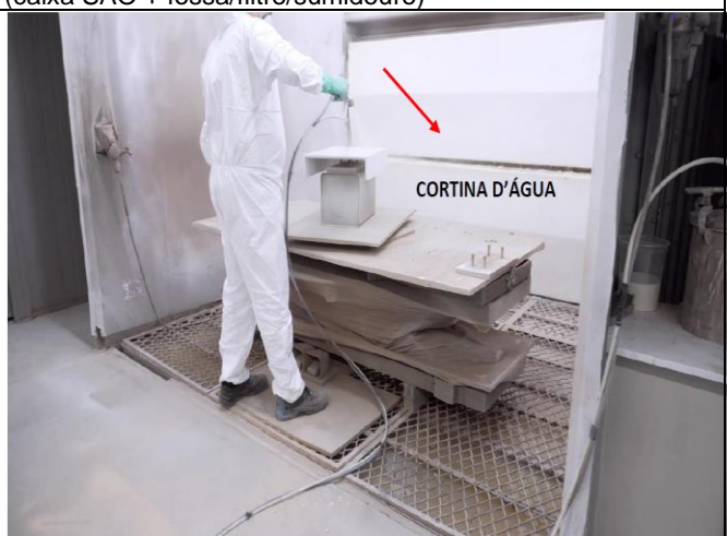
Figura 16. Cortina d'água (cabine de pintura)
