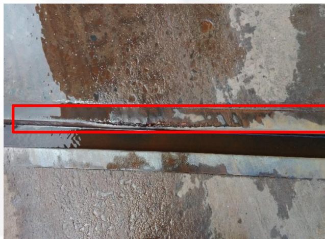
Foto 12: Canaleta corrida pela oxidação.
