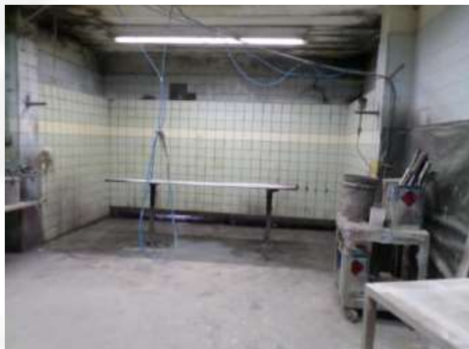
Figura 5 – Cabine com cortina d'água, setor de pintura e verniz manual.
