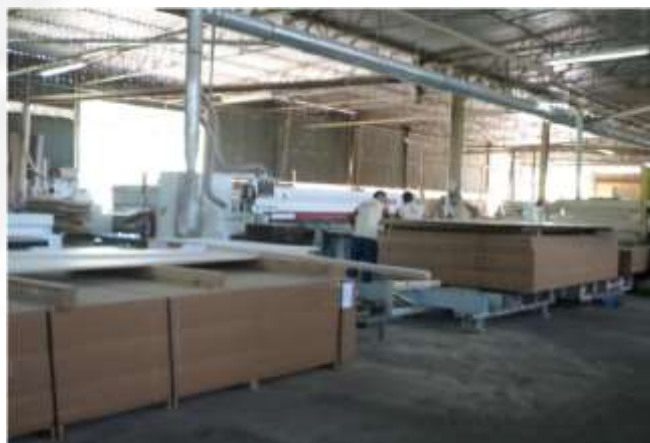
Figura 3 – Setor do corte e serraria, mostrando trabalho na seccionadora.
