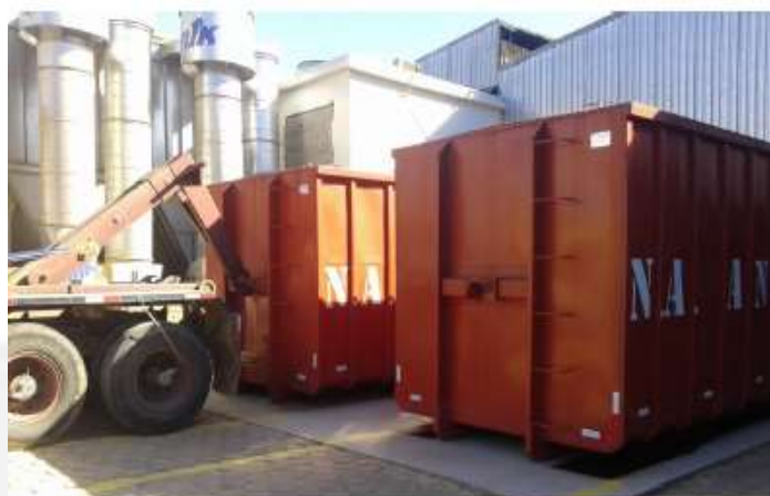
Fig. 11- Contêineres de armazenamento de material particulado.
