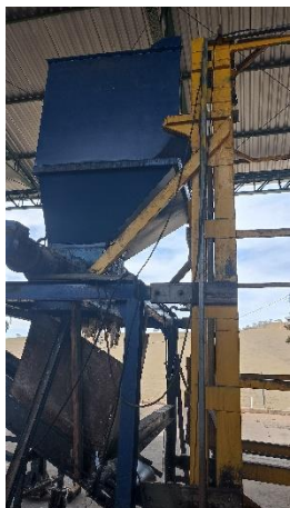
Foto 07. Triturador de resíduos (após autoclavagem)
