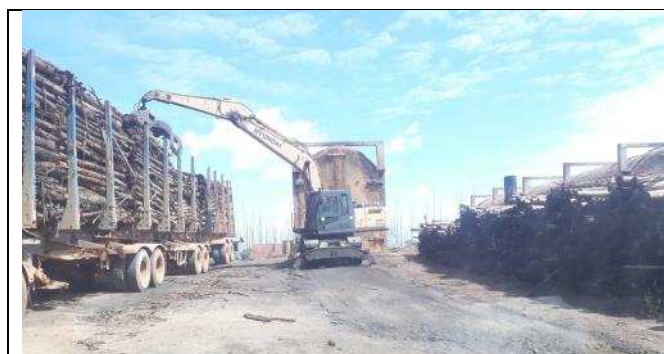
Figura 1. Forno tipo RAC e descarregamento mecanizado da madeira
