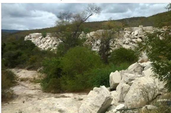
Foto 5. Pilha de rejeito/estéril.
