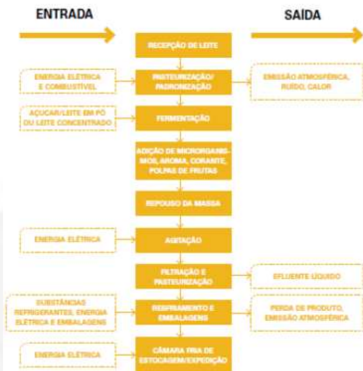
FIGURA 02 – Fluxograma da produção de iogurtes da COOPERATIVA AGROPECUÁRIA DO VALE DO SAPUCAÍ LTDA – COOPERVASS.
