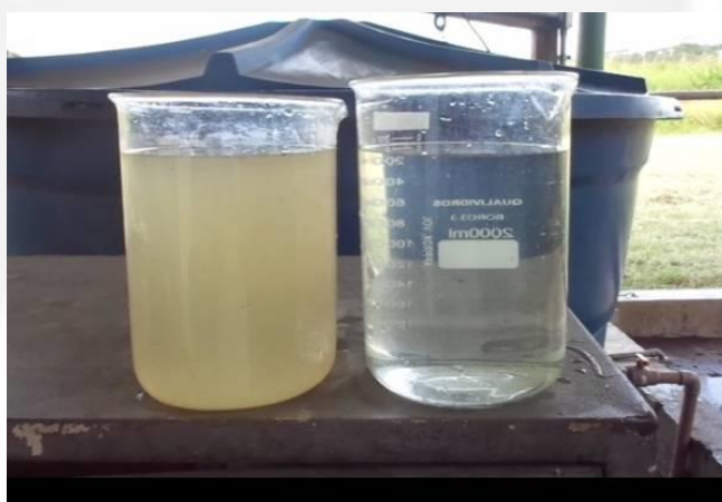
Figura 2: Efluente caixa SAO bruto e após tratamento químico para ser reutilizado (direita)
