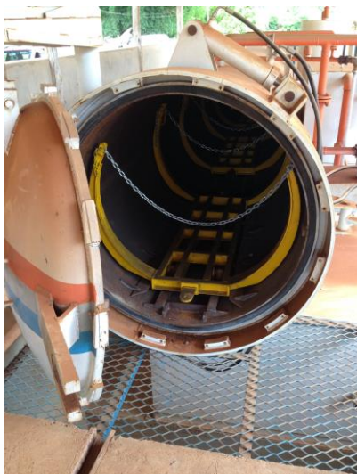
Foto 01. Vista da autoclave e o fosso de coleta de CCA.
