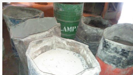
Foto 06. Cinzas geradas nas fornalhas pelo consumo de cavacos de madeira.
