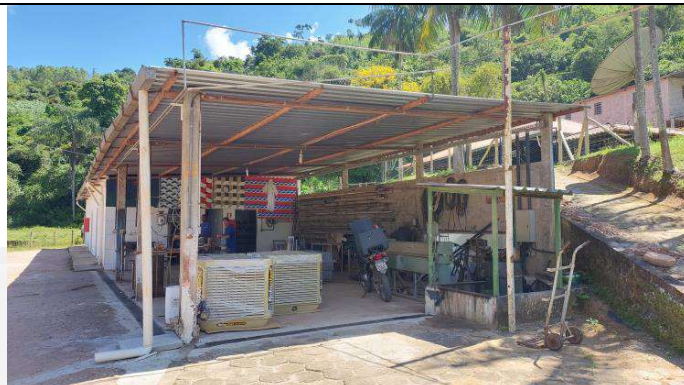
Imagem 06: Vista da oficina de reparos e manutenção de peças e equipamentos, com destaque para o piso, sistema de drenagem dos efluentes oleosos e sistema de contenção para bombonas de produtos químicos e oleosos
