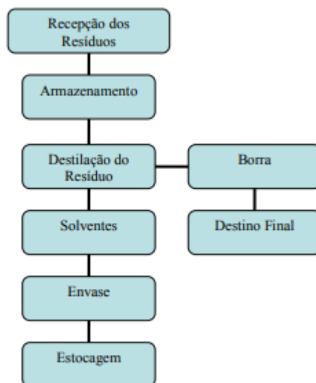
Figura 02: Fluxograma do processo industrial de reciclagem de resíduos Classe I. Fonte: RADA
