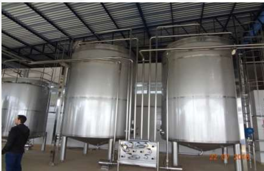
Fig. – Tanques de armazenamento de soro de leite localizados na plataforma de recepção.
