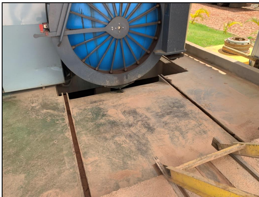
Figura 04 – Local de abertura da autoclave para colocação e retirada das vagonetes com canaletas direcionando para bacia/tanque de contenção
