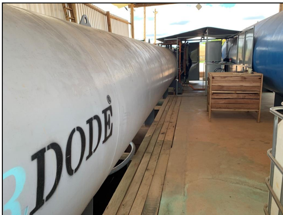
Figura 02 – Autoclave – equipamento onde é realizado o tratamento da madeira
