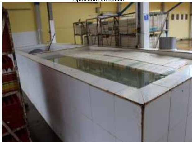
Foto30: Tanque de desinfecção dos pentes de ovos contendo solução de hipoclorito de sódio.
