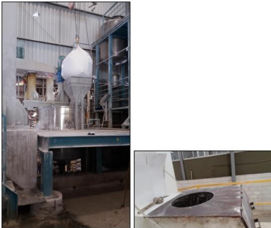
Figura 4.2.1. À esquerda: encaixe do bag na masseira. À direita: tampa presente na masseira com o local para colocação do funil do bag.
