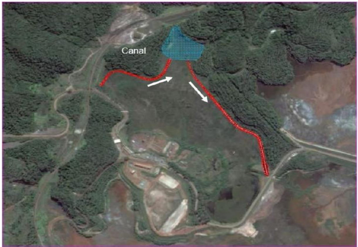
Figura 09 – Canal na Cintura de Drenagem de B5
