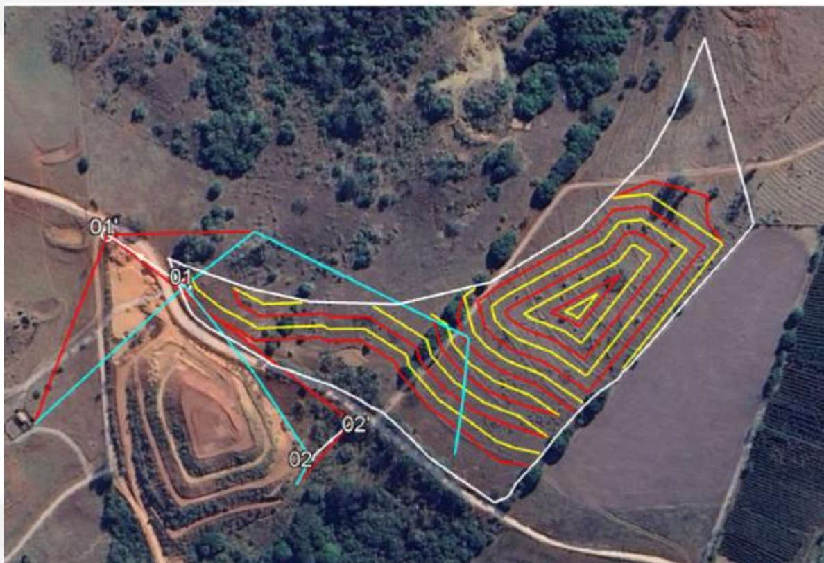
Figura 2: Linhas vermelhas e amarelas indicando onde será instalada a pilha. Linhas azuis indicam a linha de transmissão que será realocada. Fonte PCA.
