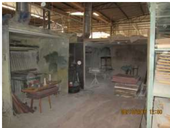
Imagem 6: Cabines de Pintura a seco, com a chicanas metálicas
