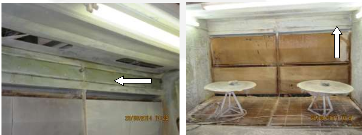
Imagens 32 e 33: Indicado pelas setas, local de acoplamento do filtro de poliéster numa cabine de verniz com sistema de cortina d’água
