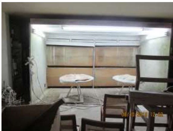
Imagem 5: Cabine de verniz com cortina d'água
