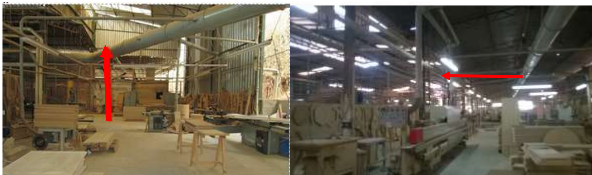
Imagens 26 e 27 (ano/2015): Sistema de controle de emissões atmosféricas indicados pelas setas VERMELHAS e com a acoplagem do sistema nas máquinas direcionadas para os silos à máquinas de corte, furação e lixação
