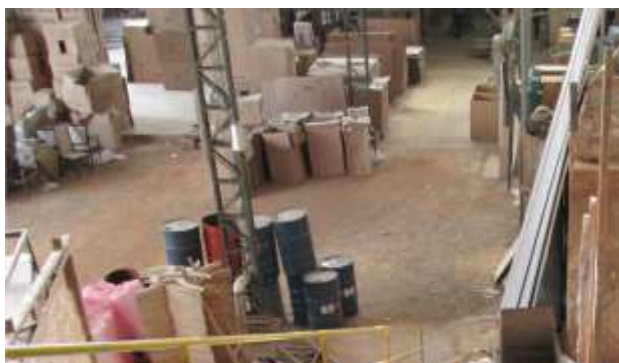
Imagem 16 (ano/ 2014): Patio de entrada da fabrica. Local utilizado para recebimento e depósito temporário de insumos e resíduos. Disposição de tambores contaminados exposto diretamente no solo.
