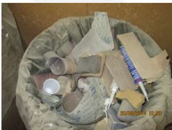
Imagem 43 (2014): Resíduos contaminados (lixa, produtos químicos, lixa, espuma) com outros resíduos comuns que passam a ficar contaminado, e consequentemente, aumentando o volume de materiais contaminados
