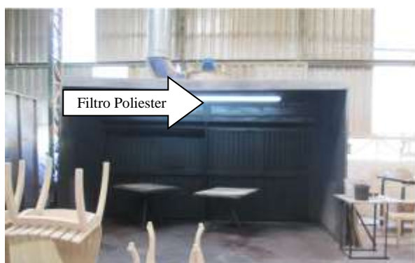
Imagens 34 e 35: Cabines secas de tingimento e verniz com sistema de chicanas metálicas e filtro de poliéster
