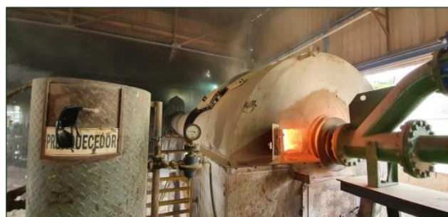
Foto 02. Forno de calcinação da unidade industrial
