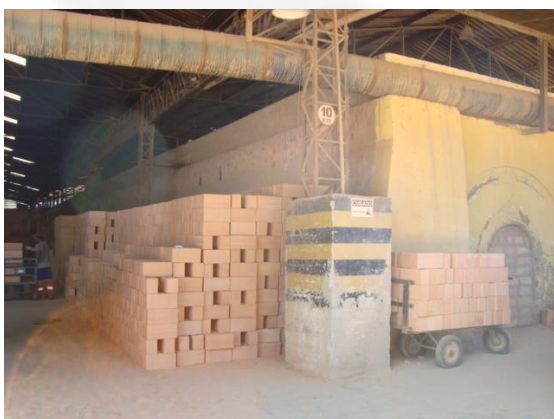
Foto 05. Forno Hoffmam usado na produção de tijolos.
