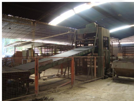
Foto 04. Extrusora (maromba) utilizada na linha de produção.
