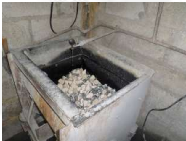
Foto 04. Etapa de Vibroacabamento das peças
