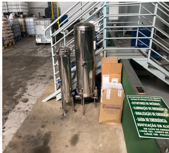
Foto 04. Equipamentos que serão utilizados no processo de recuperação de óleo lubrificante isolante e micro filtração de óleo lubrificante hidráulico.
