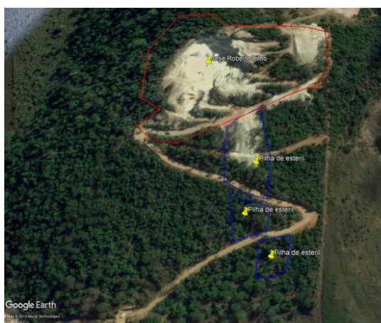
Figura 5 -Avanço da intervenção, imagem 15/06/2016. Observar início do depósito irregular de estéril, com soterramento de vegetação nativa.
