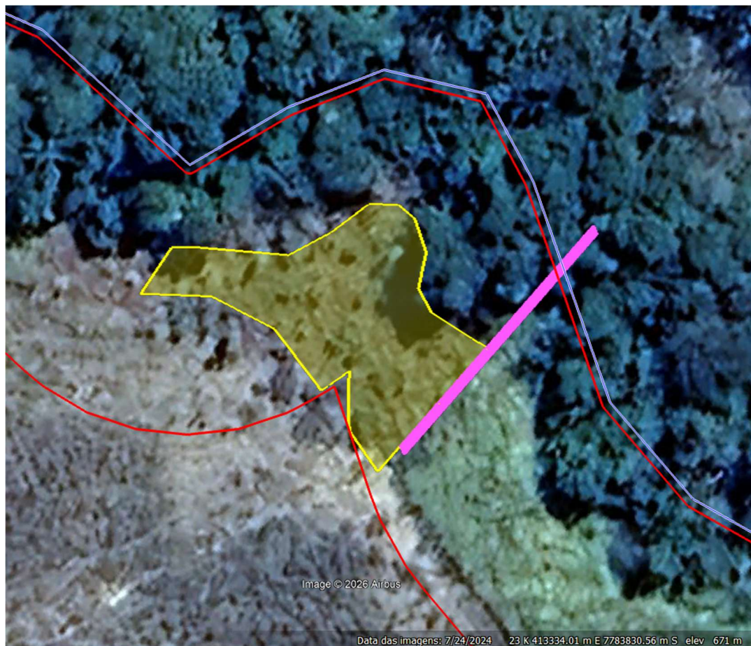
Figura 12. APP intervinda para passagem de tubulação de lançamento de efluente industrial tratado (em rosa); área proposta para compensação pela intervenção em APP (em amarelo); delimitação da APP do Rio Mombaça (em vermelho).
