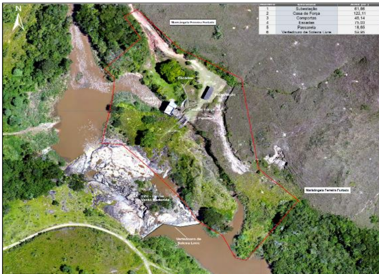
Figura 1: Ortomosaico (recorte) do empreendimento, indicando que a formação do reservatório não acarretou em alterações significativas no curso d'água, exceto pela formação do TVR. Fonte: Ortomosaico da CGH lavras, apresentado em atendimento às IC.
