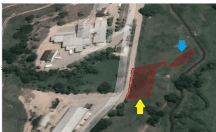
Imagem do ano de 2017 com a indicação das áreas de preservação permanente que sofreram intervenção. Pátio sobre canalização de curso d'água (seta amarela) e talude de aterro (seta azul).
