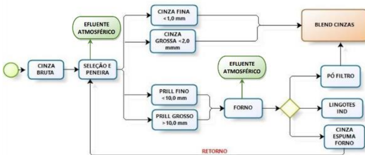
Fig. 2 – Fluxograma do processo produtivo (fonte: PCA).
