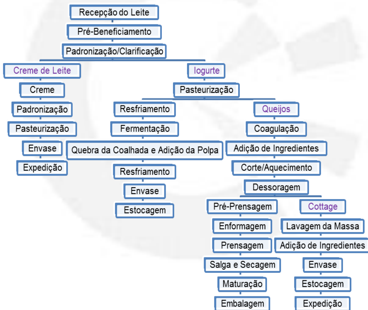
FIGURA 01 - Fluxograma resumido do processo produtivo do LATICÍNIOS VERDE CAMPO LTDA
