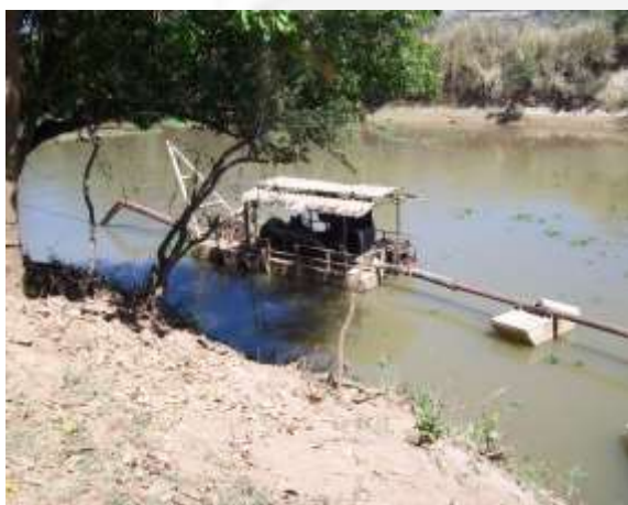
Foto 01. Dragagem para sucção de areia no leito do Rio Paraopeba.
