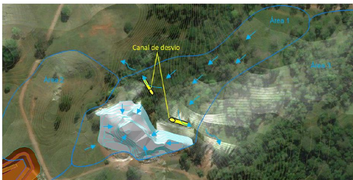
Figura 20. Fluxo de drenagem após a instalação dos canais.
