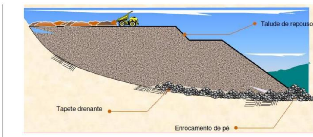
Imagem 03: Dreno de fundo da pilha
