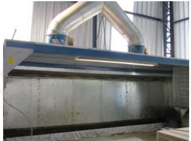
Foto 02. Cabine de pintura com cortina d'água
