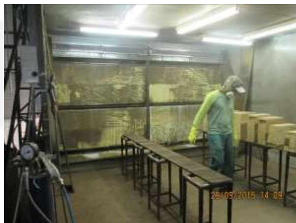
Fig. 6 – Cabine de pintura com sistema de recirculação de água, sem lançamento.
