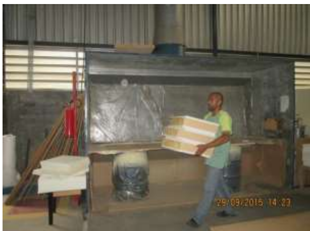
Fig. 5 – Cabine de aplicação de cola com exaustor e filtro.
