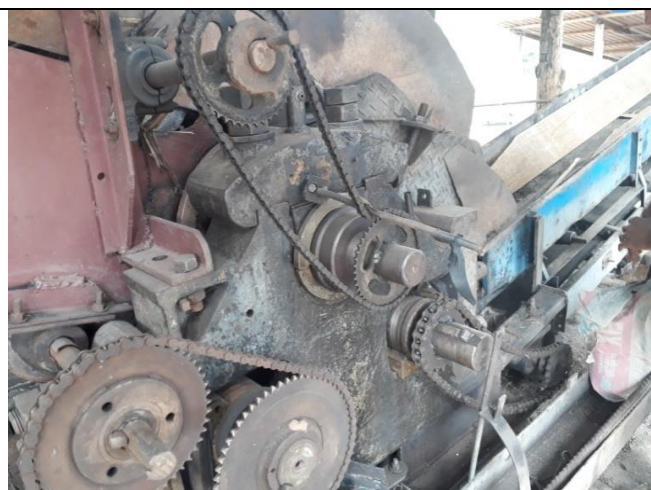
Figura 5: Moenda carente de manutenção/lubrificação.
