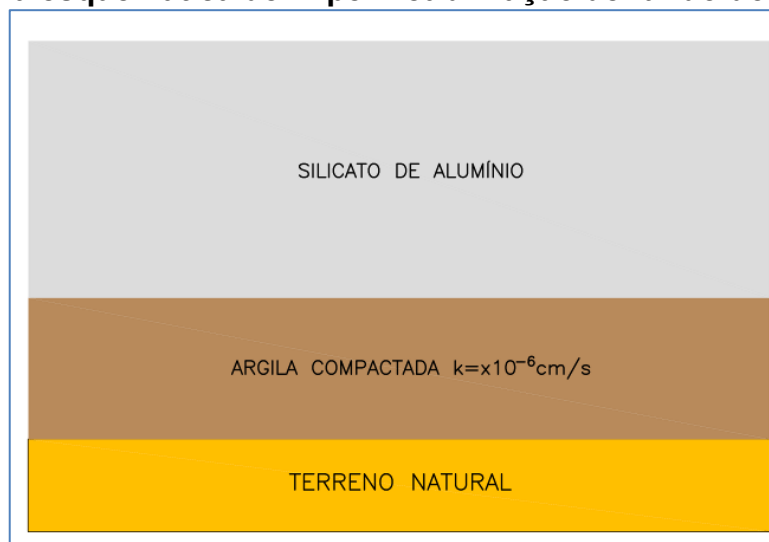
Figura 3: Figura esquemática de impermeabilização de fundo do aterro.
