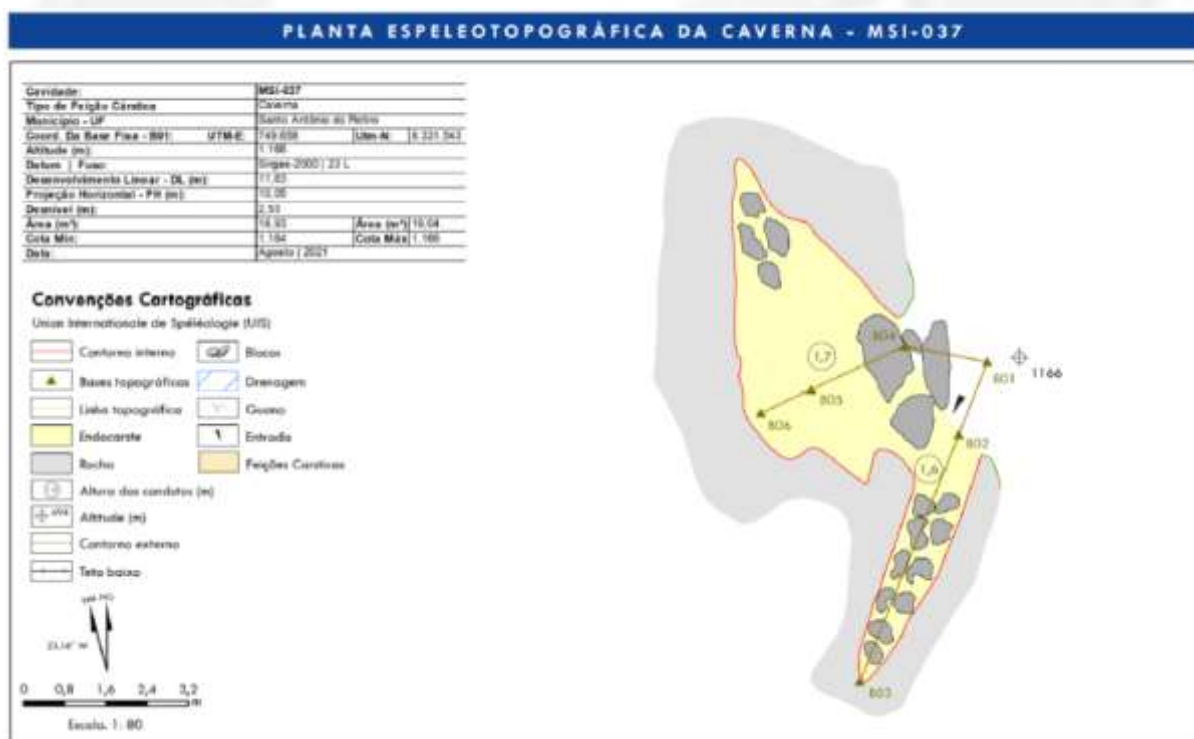
Figura 22: Planta topográfica da cavidade. Fonte: Estudo de área de influência das cavidades.
