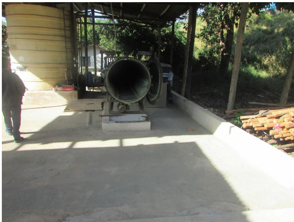
Figura 2: Área de tratamento da madeira, com autoclave e tanque. Pátio com mureta Fonte: Acervo fotográfico da vistoria
