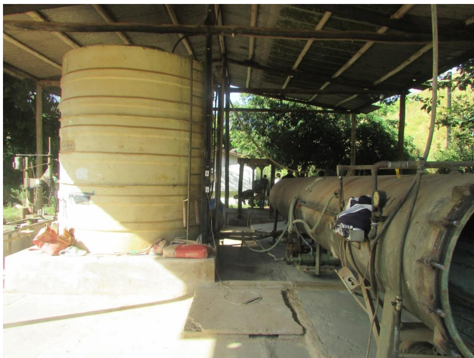
Figura 3: Tanque de armazenamento do CCA e autoclave Fonte: Acervo fotográfico da vistoria
