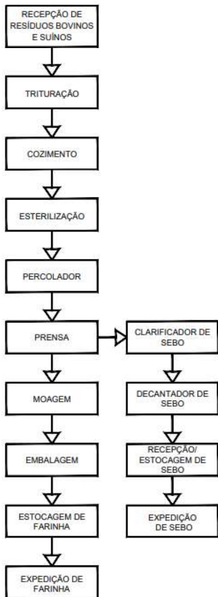
FIGURA 02 - Fluxograma da produção da farinha de carne e ossos mista, sebo (bovino, suíno e aves) e da farinha de vísceras de aves e peixe. Fonte: Relatório Ambiental Simplificado - RAS
