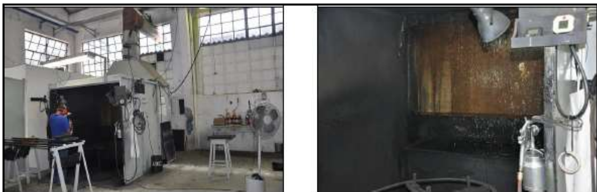
Foto 31 – Cabine de pintura com controle de emissão por cortina d'água
