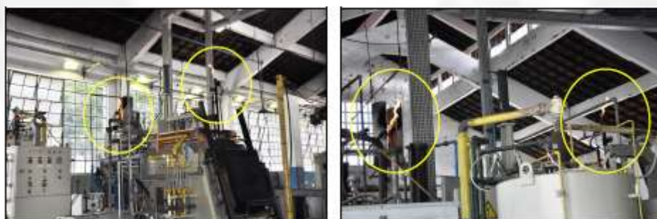
Foto 27 – Queima do gás GLP após o uso nos fornos que utilizam o gás como fonte de combustível no TTT
