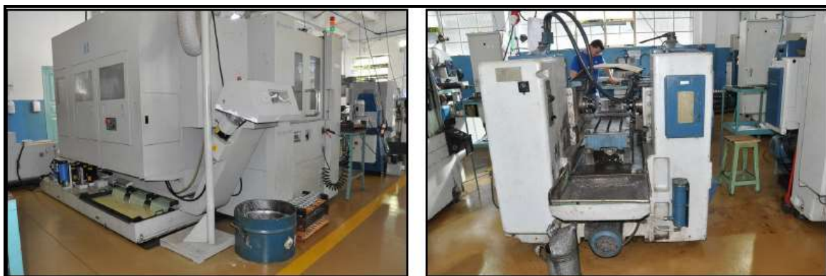
Foto 38 – Máquinas novas com dispositivo para evitar derramamento de óleo
