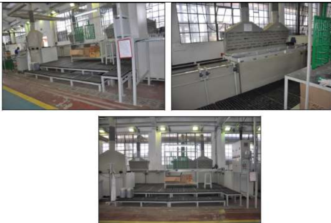
Foto 01 – Instalação e partida de linha manual de Anodização Dura no TTS
