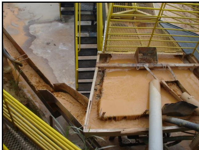
Foto 6 – Detalhe do tanque de deslamagem e canaleta metálica, à esquerda, que direciona o efluente líquido para o tratamento de decantação em baias.
