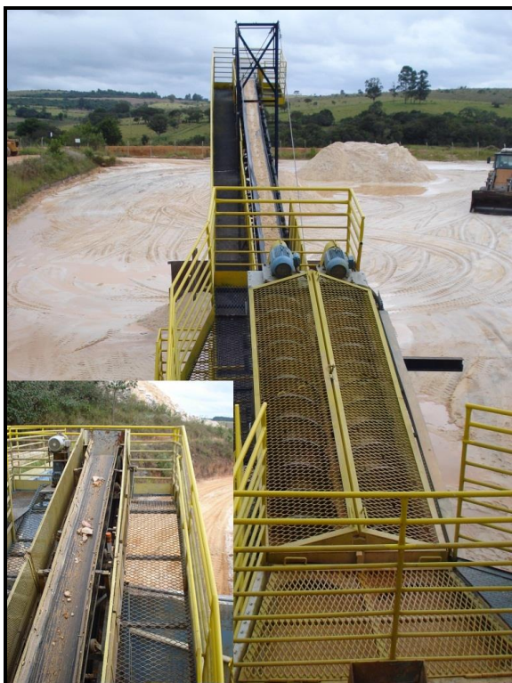
Foto 5 – Lavador de areia. Detalhe do classificador helicoidal e correia transportadora e ao fundo pátio de estocagem.
