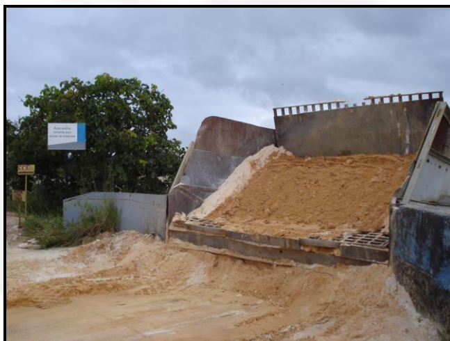
Foto 4 – Detalhe do silo com grelha para retenção dos matoos (rejeito grosso).
