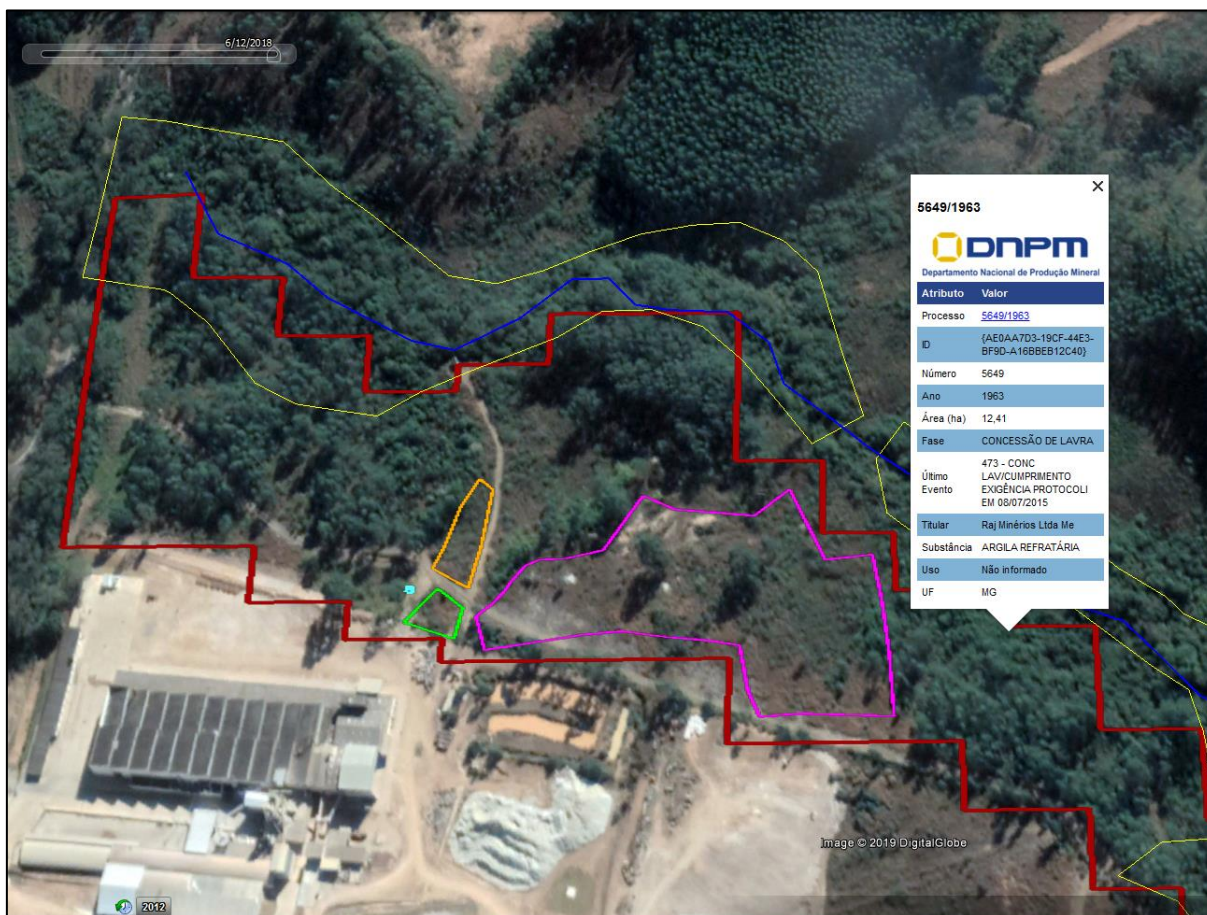
Figura 01: Delimitação da poligonal do processo ANM nº 816.211/1971 ( em vermelho ), da área de lavra ( em rosa ), da área de depósito de minério ( em laranja ), da área de estocagem de topsoil ( em verde ), do alojamento móvel ( em tiffany ), do curso d'água ( em azul ) e da Zona de Preservação Permanente – ZPP ( em amarelo ), instituída pelo município de Poços de Caldas.
