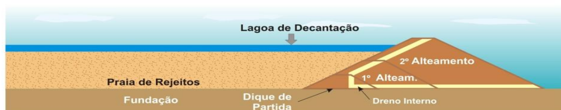
Figura 3 – Método construtivo – Alteamento à jusante
