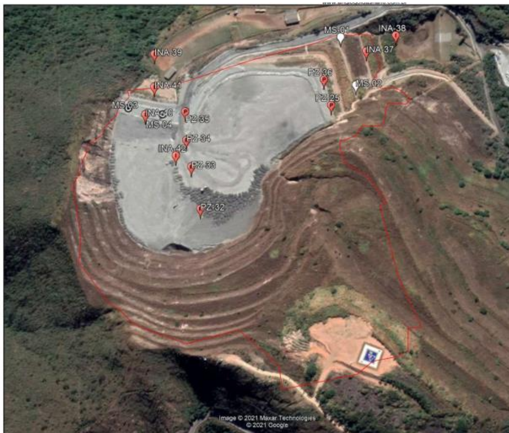
Figura 6: – Instrumentação utilizada no monitoramento geotécnico do Open Pit – O polígono vermelho representa a área de expansão. Fonte: Informações Complementares, 2021.
