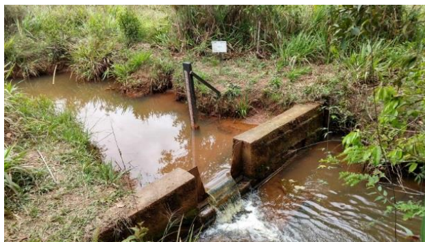
Figura 4: Régua e vertedouro para controle de vazão.
