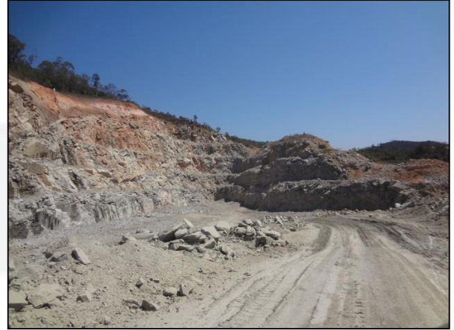
Foto 02 – Vista parcial da frente de lavra (VISTORIA SUPRAM/LM - 04/09/2019). Observa-se que a extração ocorre pelo método de bancadas descendentes com rebaixamento de cava.
