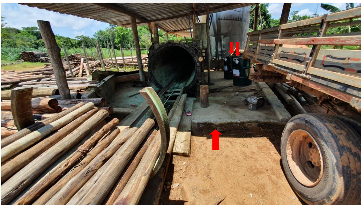
Figura 04: Entrada da autoclave demonstrando ausência de contenção próxima a porta do equipamento e o armazenamento de embalagens do produto preservativo.
