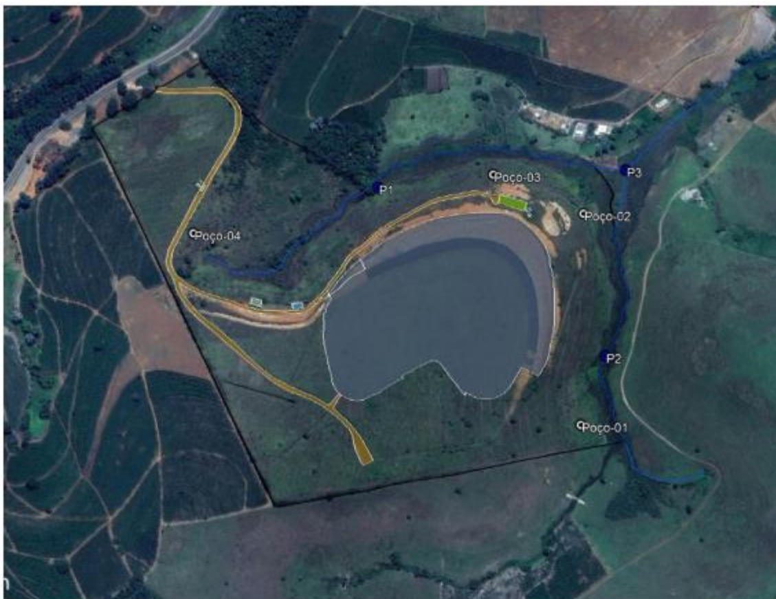
Figura 14: Rede de monitoramento proposta para o aterro sanitário: Pontos de monitoramento das águas subterrâneas, Poço-01, Poço-02, Poço-03 e Poço-04. Pontos de monitoramento das águas superficiais: P1, P2 e P3.
