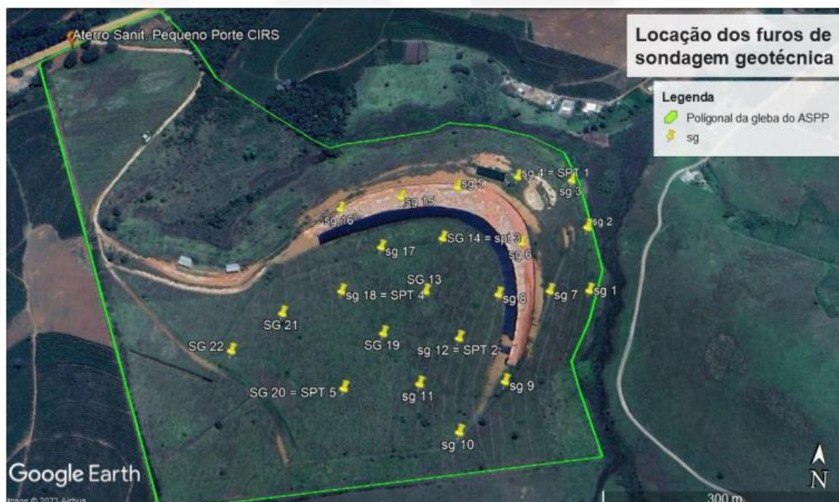
Figura 06: Locação dos furos de sondagem geotécnica (sg) e sondagem à percussão (SPT) na gleba do aterro.
